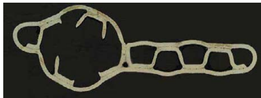
实际压爆效果，极限压力18.2MPa
